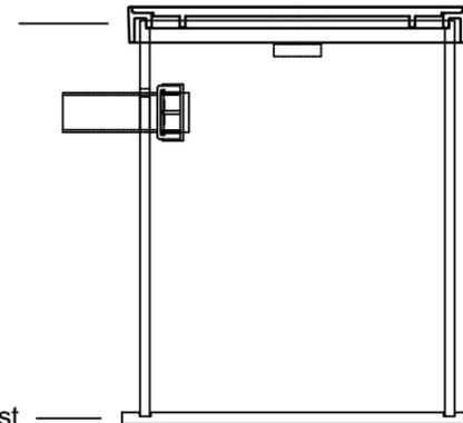
Schachtkörper auf eingekerpte Bodenplatte geschweisst
